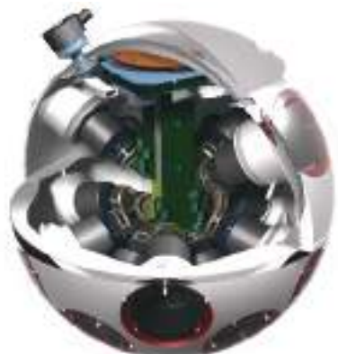
Foto 2 - Modulo del KM3NeT (unità di rilevazione DTU) dotata di 18 moduli ottici digitali (Digital Optical Module) ciascuno contenente 31 fotomoltiplicatori sensibili alla luce
