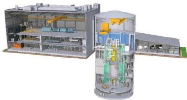
Fig: 8 – Rappresentazione di impianto SMR.
