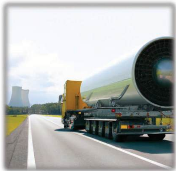
Fig. 6 – Trasporto su strada di un modulo SMR
