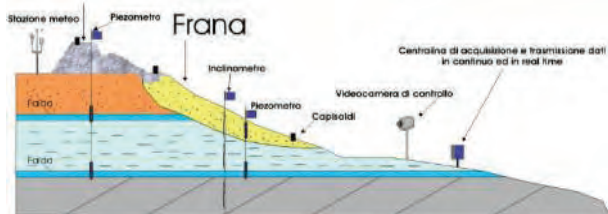
Fig. 5: Schema tipo monitoraggio dei versanti basato sul superamento di valori soglia. (fonte: www.cedateuropa.eu)
